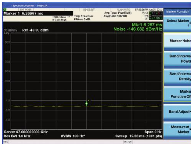
Рисунок 3. Пример измерения среднего уровня собственных шумов (DANL) для смесителя серии 11970 на частоте 67 ГГц, нормализованного к полосе пропускания 1 Гц и выдающего результат -128,6 дБм.
