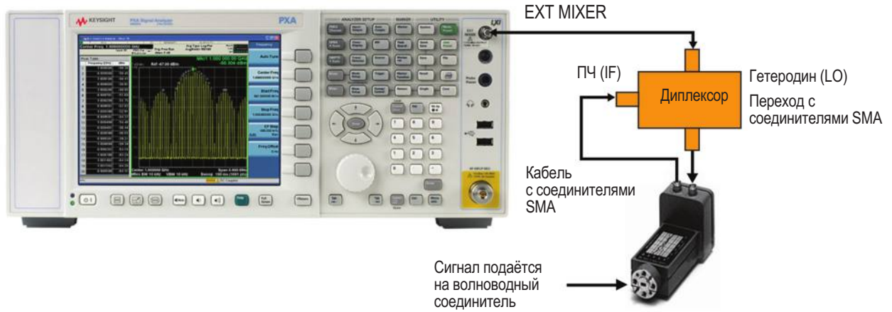
Рисунок 1. Средства подключения устаревших смесителей серии 11970 включают дуплексер и дополнительные компоненты для сопряжения с анализатором сигналов PXA.
