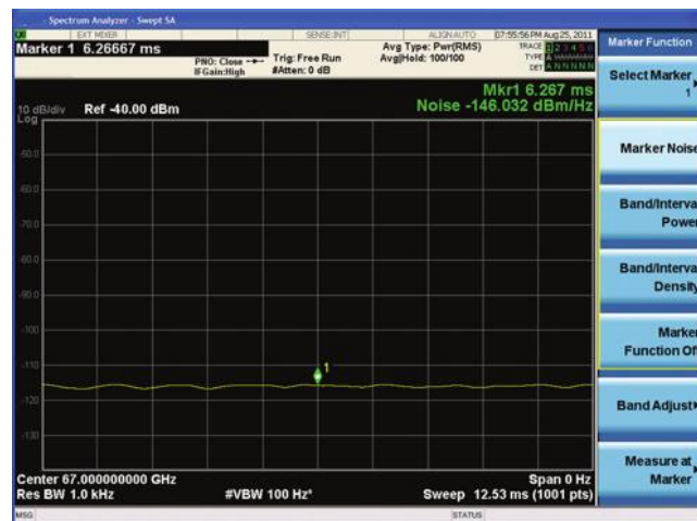
Рисунок 4. То же самое измерение среднего уровня собственных шумов (DANL) с интеллектуальным смесителем на гармониках на частоте 67 ГГц, нормализованное к полосе пропускания 1 Гц, выдаёт результат -146,0 дБм.
